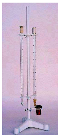
Figura 16 – Psicrômetro não aspirado Fonte: http://www.imn.ac.cr
