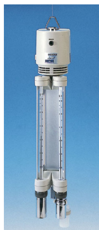
Figura 15 – Psicrômetro aspirado Fonte: http://www.mesdan.it
