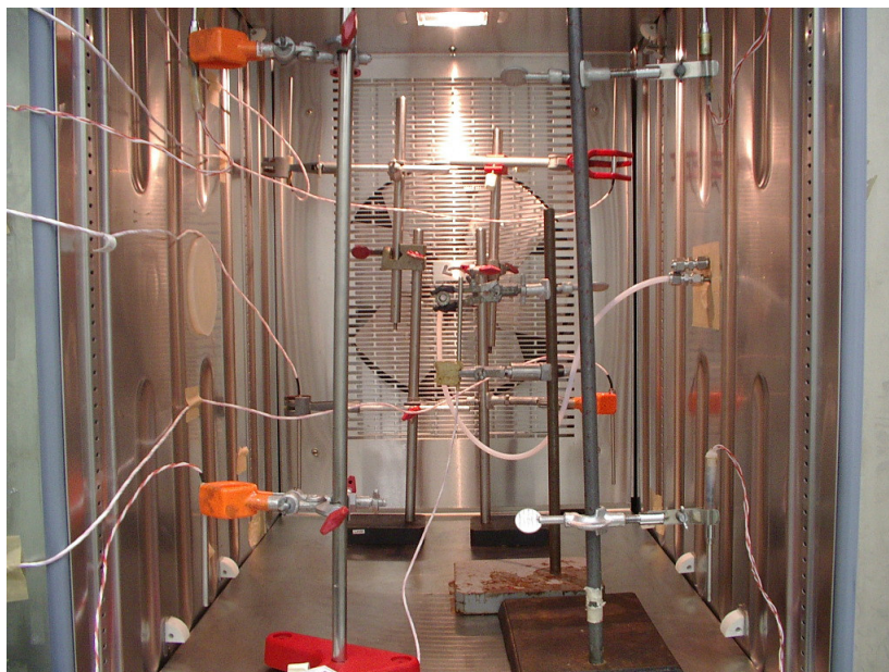
Figura 39 – Sistema de medição no interior da câmara Fonte: Elaboração própria
