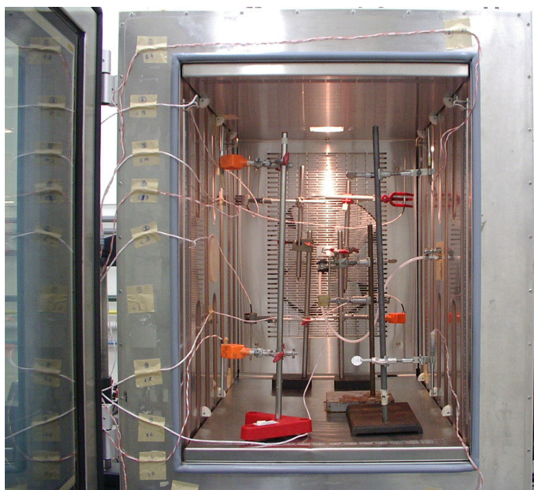
Figura 38 – Sistema de medição no interior da câmara Fonte: Elaboração própria
