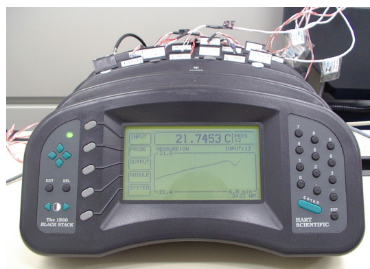
Figura 32 – Indicador digital de temperatura Fonte: Elaboração própria
