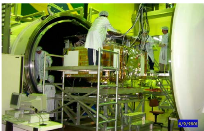
Fig. 3 – Ensaio vácuo-térmico no satélite CBERS 2 (Satélite Sino Brasileiro de Recursos Terrestres)
