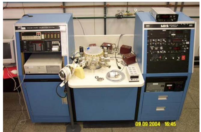
Fig. 2 – Sistema de calibração de alto vácuo Lapre/Inmetro
