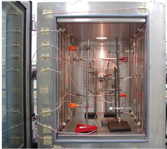
Fig. 2. Sistema de medição no interior da câmara
