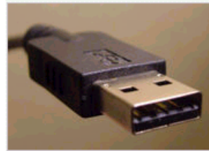
Fig. 3: Conector de acordo com a norma USB Fonte: http://pt.wikipedia.org/wiki/Universal_Serial_Bus
