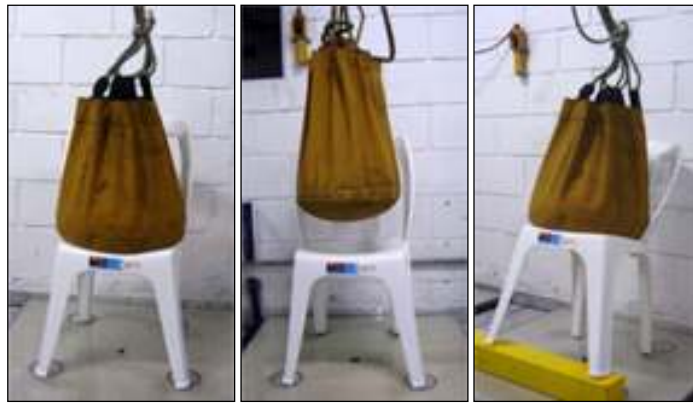
Figura 2 - Ensaio de carregamento estático (1), resistência ao impacto (2) e resistência das pernas traseiras (3).
